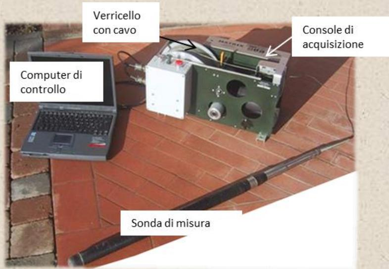
Setup della strumentazione minima per effettuare logs in foro
